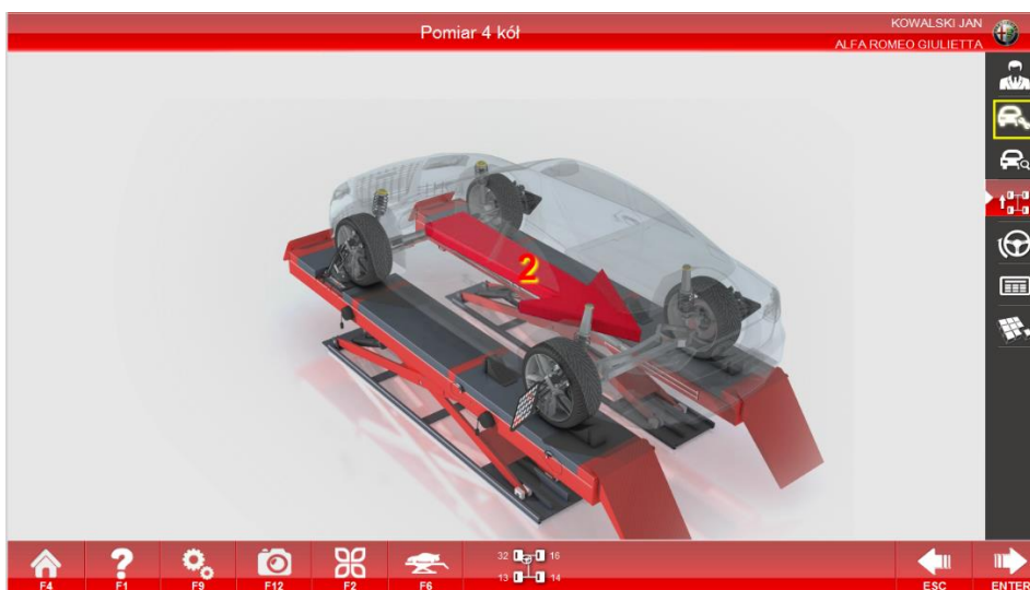
Pomiar kompensacji przez przetaczanie czterech kół pojazdu_3
