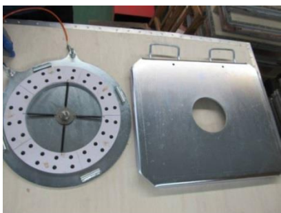
(Demontaż stalowej obrotnicy na dwie części)
