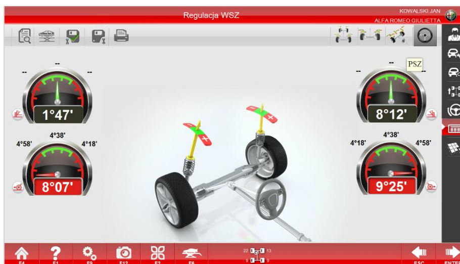
Pomiar kąta wyprzedzenia sworznia zwrotnicy
