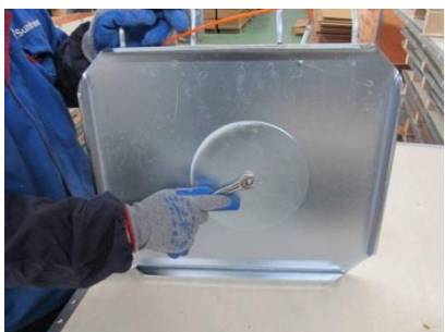
(Demontaż stalowej obrotnicy)
